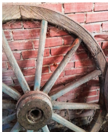
Lato interno della ruota: ben visibile uno dei cavéj con i relativi due raggi, che a loro volta vanno a innestarsi nel mozzo
