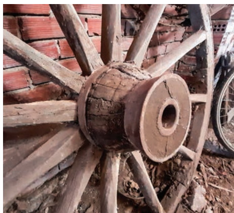
Lato esterno della ruota con la protuberanza del mozzo; al centro, il cilindro in ferro in cui andava ad inserirsi la punta dell'assale
