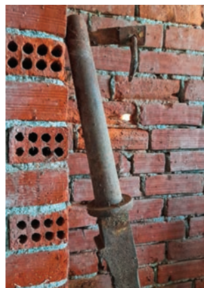
Parte terminale dell'assale, che andava ad inserirsi nel mozzo. In alto, uno dei due cavicchi in ferro (la cavija), che tenevano le ruote assemblate al carro.
